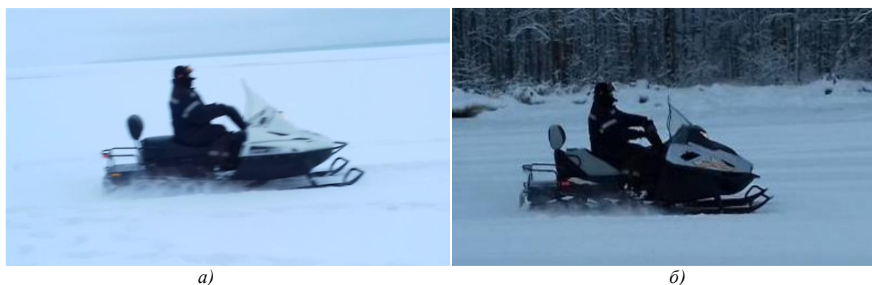
Рис. 6. Фрагмент проведения испытаний тяговой динамики снегоходов: а - снегоход «Тайга Варяг 550»; б - снегоход «Тайга Патруль 800 SWT»
