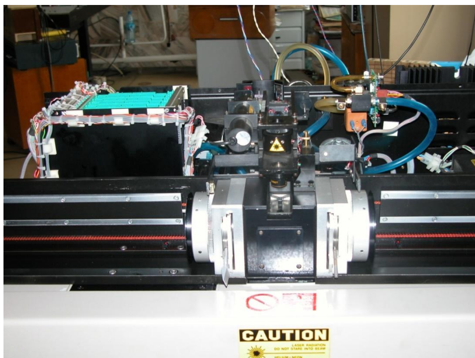
Рис. 3. Измерительная ячейка анализатора заготовок Р-102
