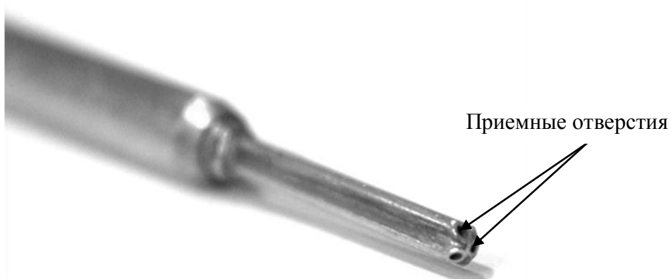
Рис. 2. Чувствительная часть пятиканального пневмометрического зонда
