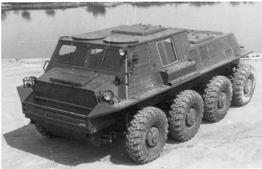
Рис. 2. Ходовой полноразмерных макет колесного шасси ГПИ-3901
