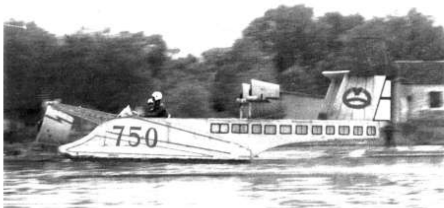
Рис. 9. Первый китайский экраноплан модели 750 с дополнительной силовой установкой
