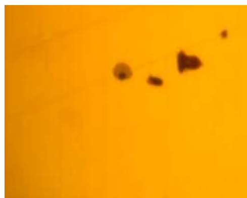
Рис. 3. Включения оксисульфидов в светлом поле зрения, \times 300
