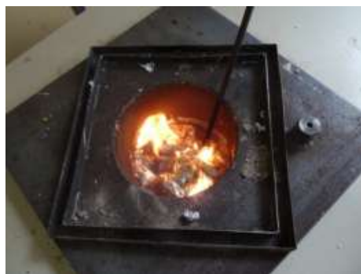
Рис. 2. Интенсивное газообразование «вспученная» поверхность теплоносителя. Пузырь достигает поверхности расплава, но газ еще скрыт слоем металла. (Система улавливания газа снята)
