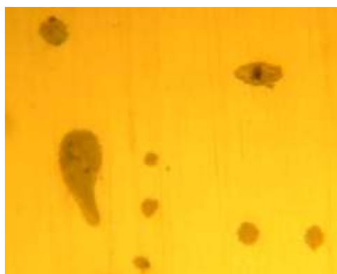
Рис. 3. Включения оксисульфидов в светлом поле зрения, \times 300
