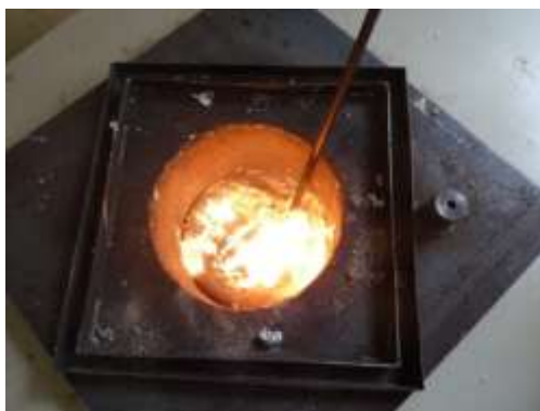
Рис. 3. Пузырь лопнул, газ имеющий температуры 700 – 1200 °С, воспламенился при контакте с кислородом воздуха. (Система улавливания газа снята)
