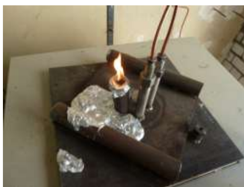
Рис. 4. Реактор закрыт системой улавливания газов. Горение газа в сбросном окне, видны капли металла, выброшенного из реактора при скачке давления
